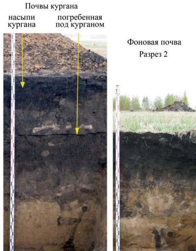
Рис. 2. Почвы изученного кургана и современная (фоновая) почва рядом с курганом. Fig. 2. Soils of the studied mound and modern (background) soil next to the mound.
