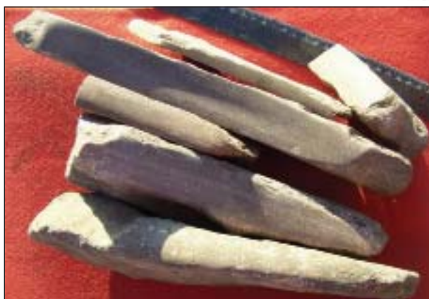
Рис. 12. Торцовые шлифовальные плиты.
