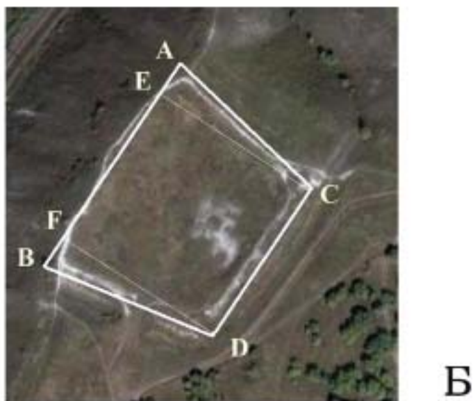
Рис. 6. Параметрические характеристики строительных блоков и вынос проекта крепости на местность. А – вариабельность параметрических характеристик блоков; Б – разбивка плана крепости в виде равносрорной трапеции на местности.
